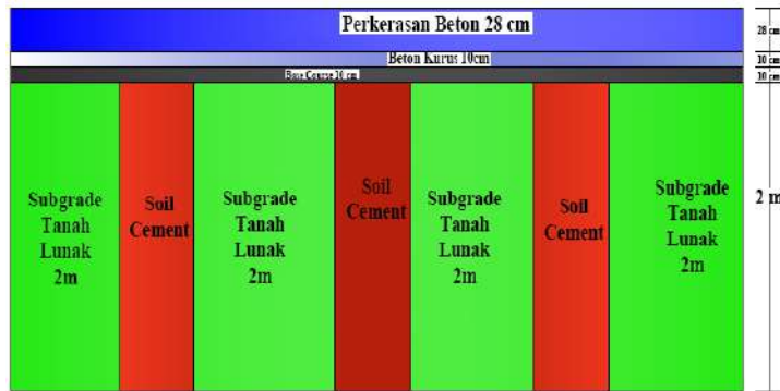
Gambar 2. Pemodelan dengan Kolom soil cement
