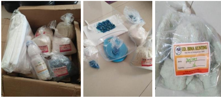
Zat fiksator tawas, kapur, prussi, tunjung
