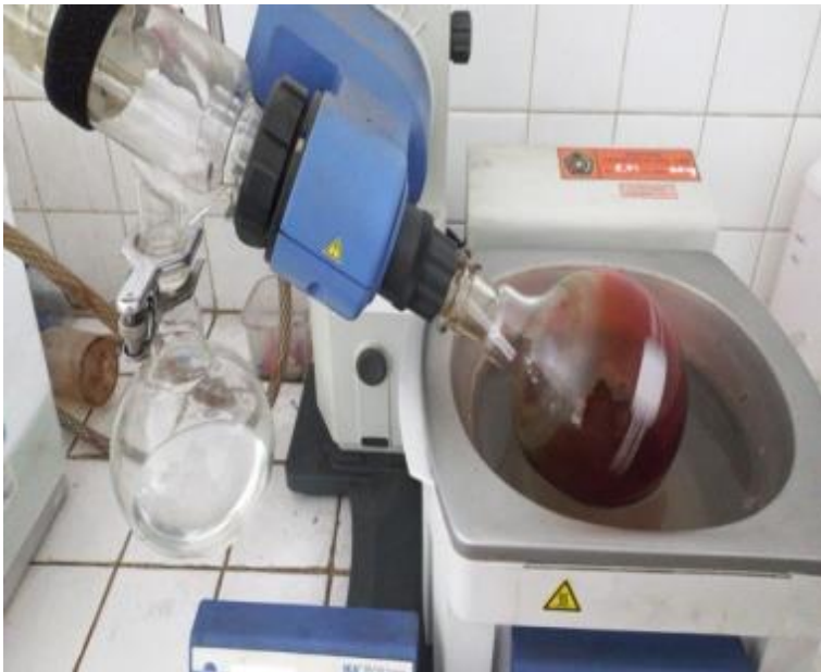
Pengentalan dengan Rotary Evaporator
