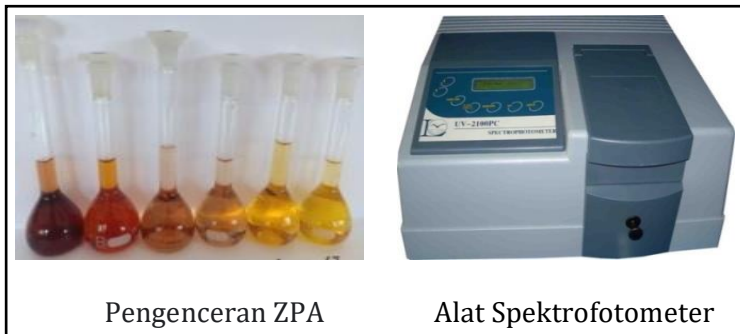
Gambar 3.8 Uji absorbansi/ intensitas ZPA
